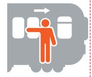
Опасно прикасаться к металлическом к металлическом му корпусу вагона и дверям до отключения высокого напряжения по всему участку
