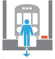
Идите вдоль полотна между рельсами, неприкасаясь к токоведущим шинам (сбоку от рельсов), во избежание поражения электрическим током
